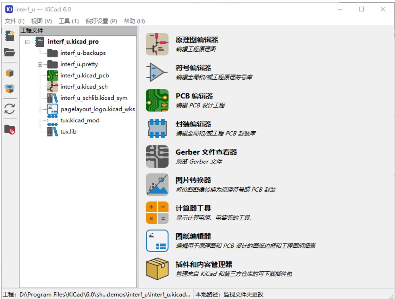
KiCad 工程管理器窗口由左侧的树状视图和右侧的启动器组成，前者显示与打开的工程相关的文件，后者则包含各种编辑器和工具的快捷方式。
