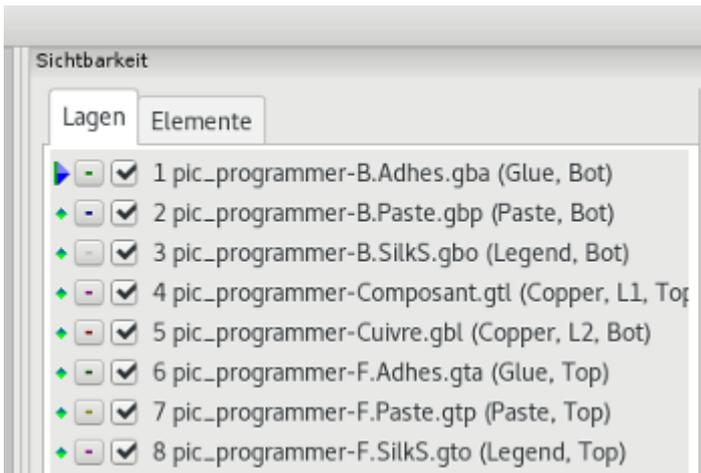
Der Lagenmanager kontrolliert und zeigt die Sichtbarkeit aller Lagen an. Ein Pfeil zeigt die aktuell gewählte Lage, jede Lage kann durch Checkboxen eingeblendet oder ausgeblendet werden.
