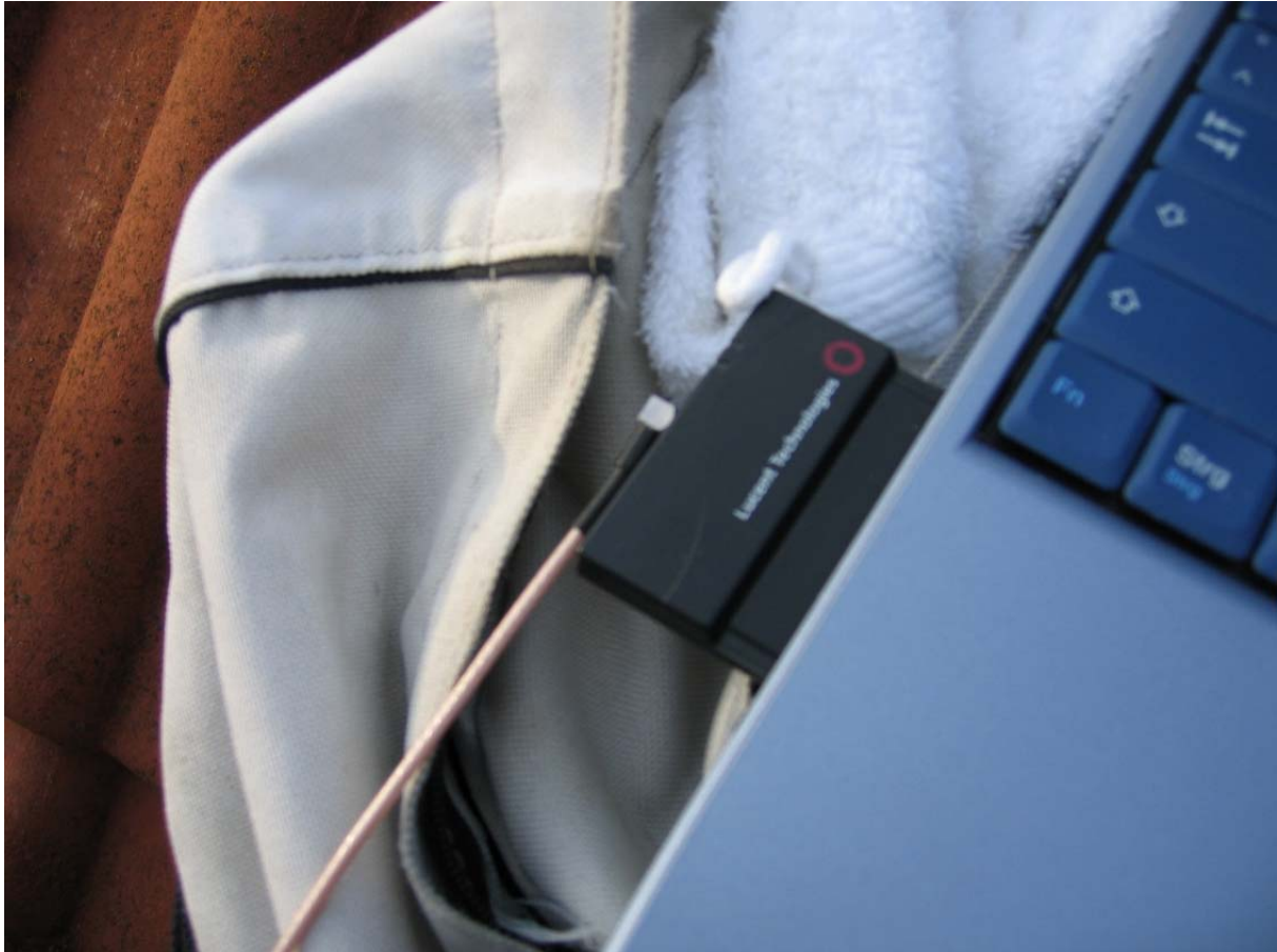
PCMCIA Netzwerkkarte mit externem Antennenanschluss am Gebäude B
